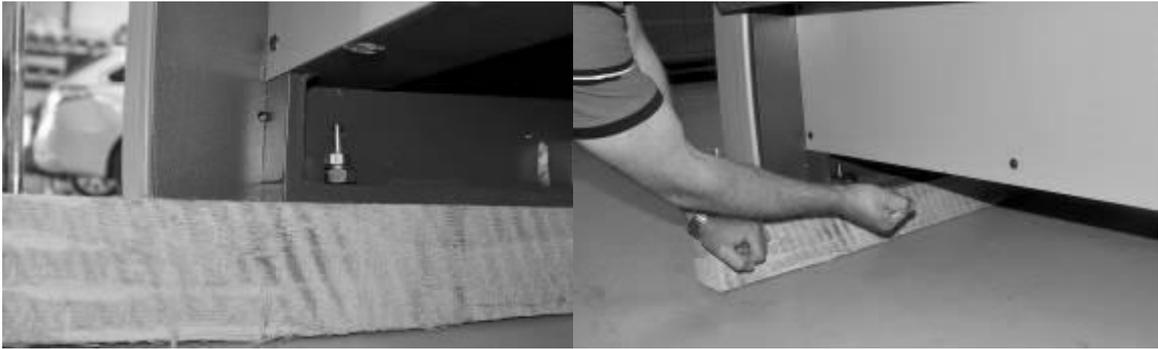
6. Nun kann die Schere mithilfe eines Gabelstaplers, dessen Gabel unter den mittleren Balken fasst, von den Balken gehoben werden. Die Schere kann unter dem Scherenboden, wie im Bild dargestellt, angehoben werden.
