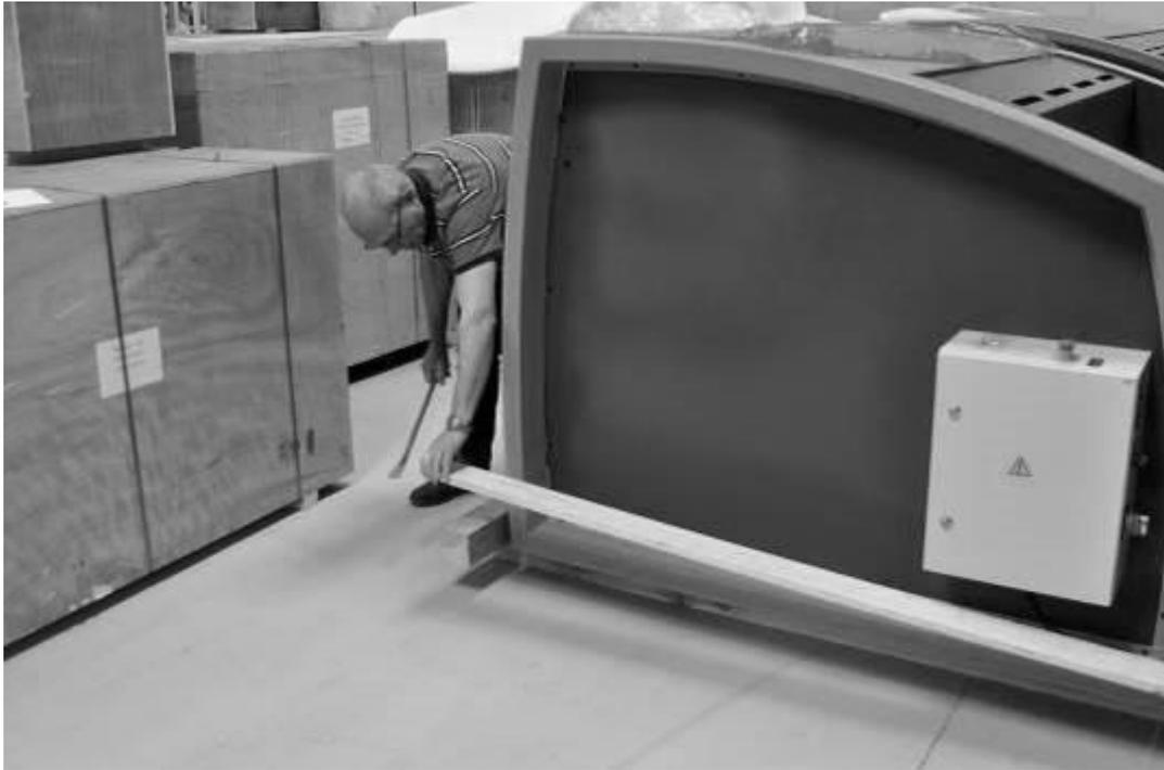
4. Schrauben Sie die Muttern des ersten Balkens ab und entfernen Sie den Balken.
