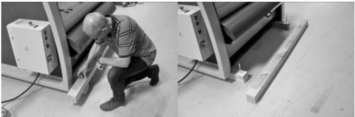
5. Schrauben Sie die Muttern der Schrauben ab, mit denen die Schere an den Balken fixiert ist. Insgesamt sind dies 4 Muttern!
